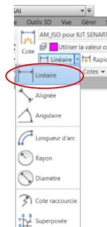
Sélectionnez le coin bas gauche de la vue de face puis l'extrémité basse du trait d'axe vertical du perçage lamage.
