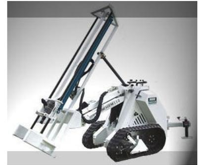
Le système est autonome. On utilise un moteur thermique pour générer l'énergie mécanique primaire. Un système de 2 pompes hydrauliques indépendantes permet pour la première de fournir l'énergie hydraulique vers les 2 moteurs hydrauliques des roues ; la seconde sert à la partie forage.
