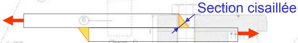
Fixation par boulonnage :
